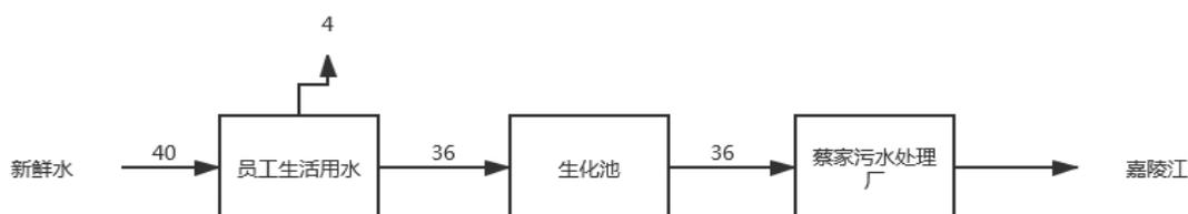
图 2-1 项目水平衡图（单位：m<sup>3</sup>/d）
