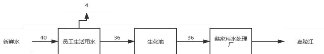
图 2-1 项目水平衡图（单位：m 3 /d）
